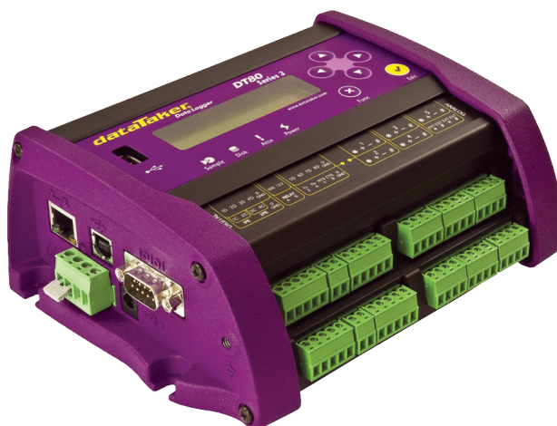
Obrázek 2.1: Záznamové zařízení DT80 od společnosti CAS dataloggers
