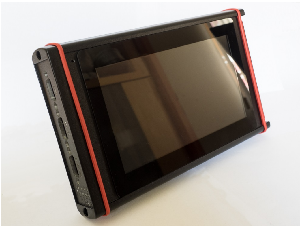
Obrázek 5.1: Mechanické zapouzdření jednotky s vyfrézovanými otvory v bočnicích a s namontovaným displejem
