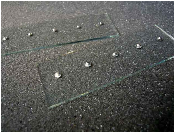
Obr 18: Body napájené na sklo
