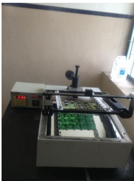
Obr 3: Souprava na pájení ponorem
