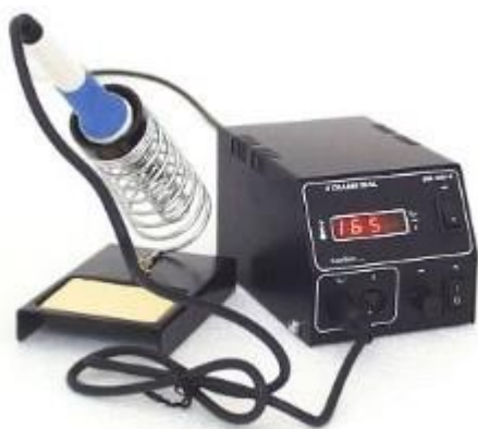
Obr 2: souprava pro ruční pájení (pájení pájedlem)
