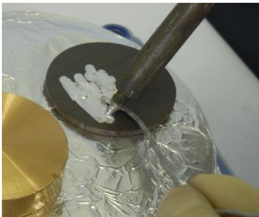
Obr 21: Pájení na keramiku
