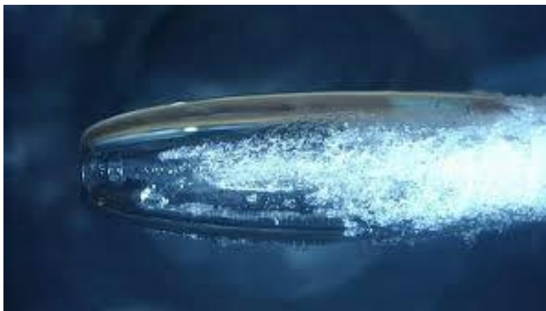
Obr 10: Kavítace v kapalině
