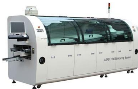
Obr 6: Zařízení na pájení vlnou
