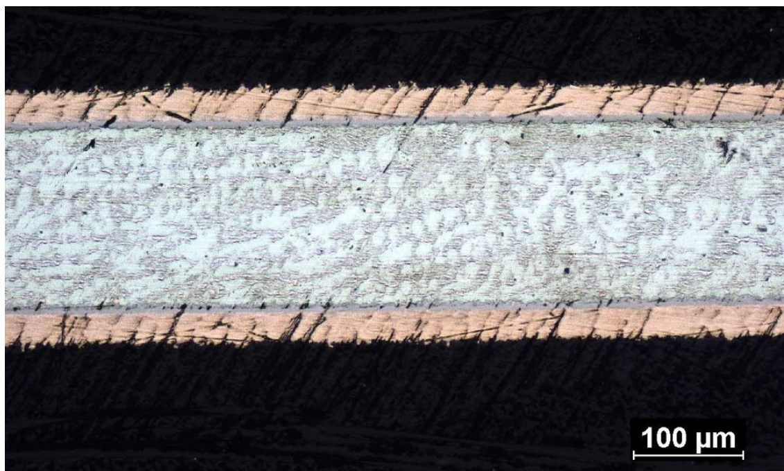
Obr. 37: Výbrus pájeného spoje s Sn93Ag6,5Cu0,5 a bezolovnatou pastou
