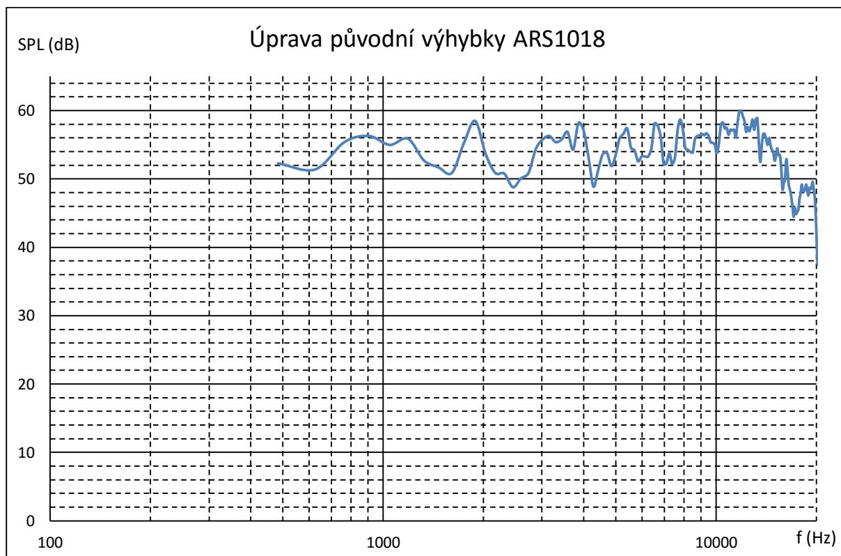
Obr. 17 Amplitudová charakteristika ARS1018 s nastavením upravené původní výhybky
