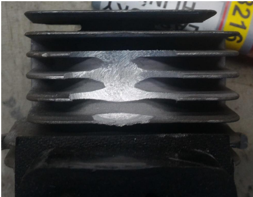
Obrázek 5.3: Odfrézované žebrování válce
