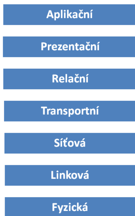
Obrázek 2.1: Vrstvy ISO/OSI modelu
