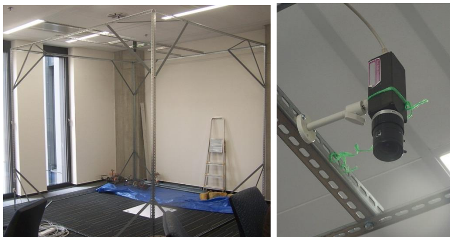
Obr. 17 Experimentální aréna s podstavou 3x3m a výškou 2,6m a upevnění kamery Elphel NC353L
