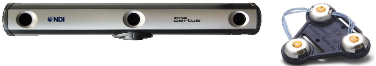
Obr. 9 Senzor a aktivní značka pro 6DoF lokalizaci systému Certus HD, zdroj [12]
