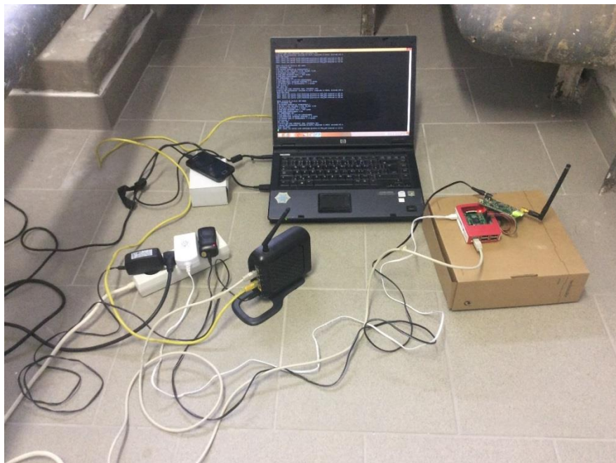
Obrázek 7-9 Měřicí pracoviště s koncentrátorem WiMOD iC880A pro příjem paketů
