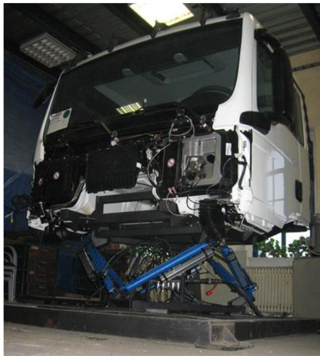
Obrázek: 4 Interaktivní simulátor nákladního vozu MAN
