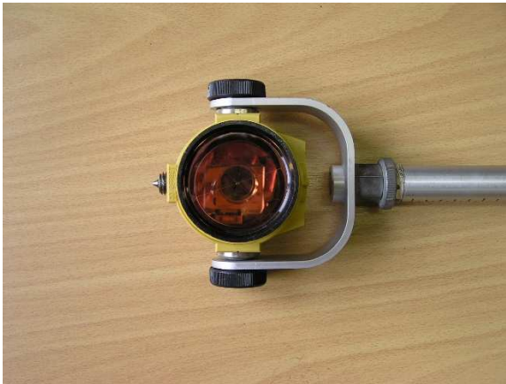
Obr. č. 6 Pasivní odrazné prvky, zleva koutový odražeč, odrazný terčik 4
