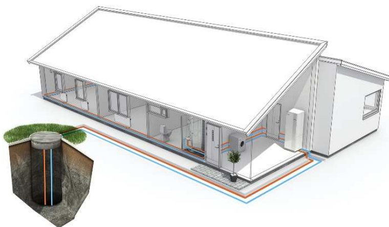
Obrázek 7: Princip tepelného čerpadla země-voda (Zdroj: nibe.cz)
