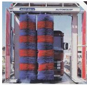
Překrývání kartáčů při mytí přední i zadní části vozidel
