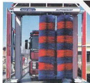
Překrývání kartáčů při mytí přední i zadní části vozidel
