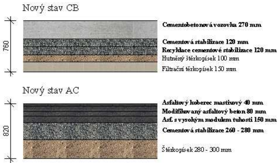
obr. 4. 14 Skladba zrekonstruované vozovky dálnice D1
