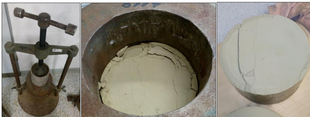
Obr. 38 – vlevo – ruční lis, vprostřed – válcové těleso před vytlačněním, vpravo – válcové těleso po vytlačnění
