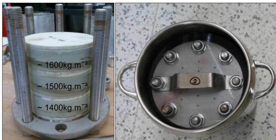
Obr. 37 - vlevo – válcová tělesa s karborundovými destičkami před uzavřením v tlakové nádobě, vpravo – tlaková nádoba uložená v tlakovém hrnci
