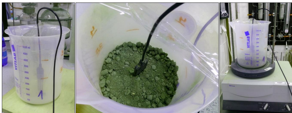
Obr. 30 – vlevo - instalovaný senzor pro měření pelet, vprostřed - obsypání peletami, vpravo – hutnění
