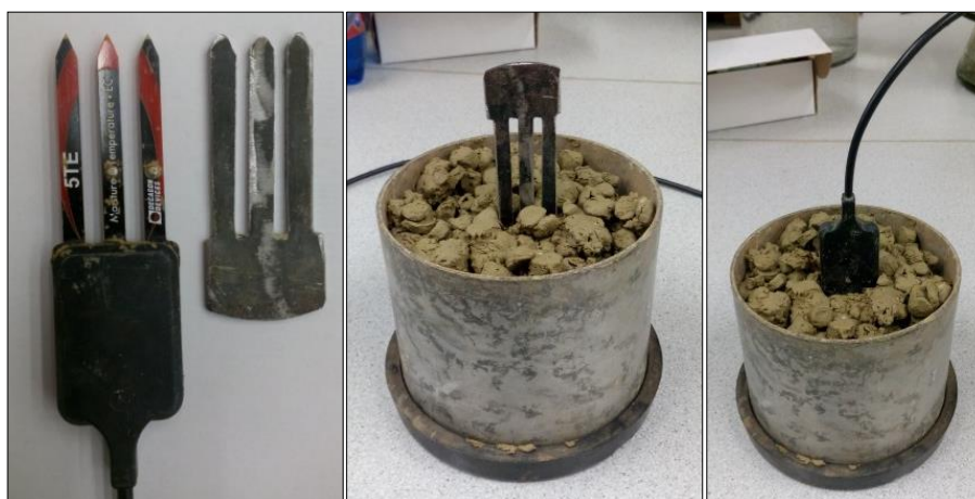
Obr. 31 – vlevo - šablona senzoru, vpravo – příprava vzorku pro instalaci senzoru
