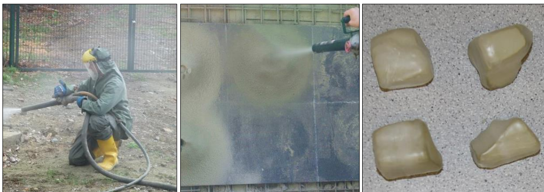
Obr. 13 – vlevo – nástřik, uprostřed – souvislý nástřik, vpravo – vzorky preparované parafinem
