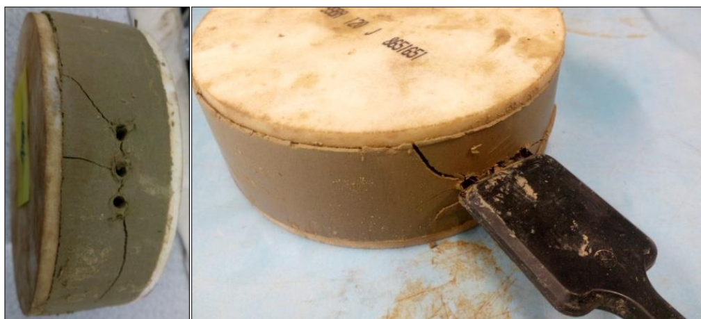
Obr. 39 – vlevo - vyvrtané otvory pro instalaci senzoru, vpravo – měření
