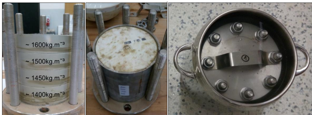
Obr. 36 – vlevo a vprostřed – příprava před uzavřením tlakové nádoby, vpravo – uložení v tlakovém hrnci
