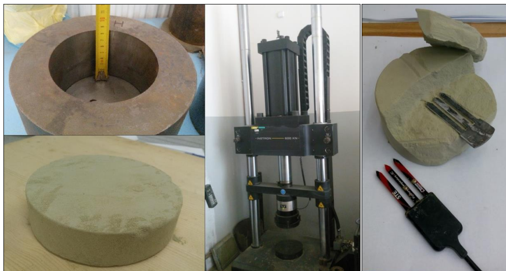
Obr. 33 – vlevo nahoře - lisovací forma, vprostřed - vysokotlaký lis, tvarovky vysoké objemové hmotnosti (vlevo dole), vpravo - rozlomený vzorek
