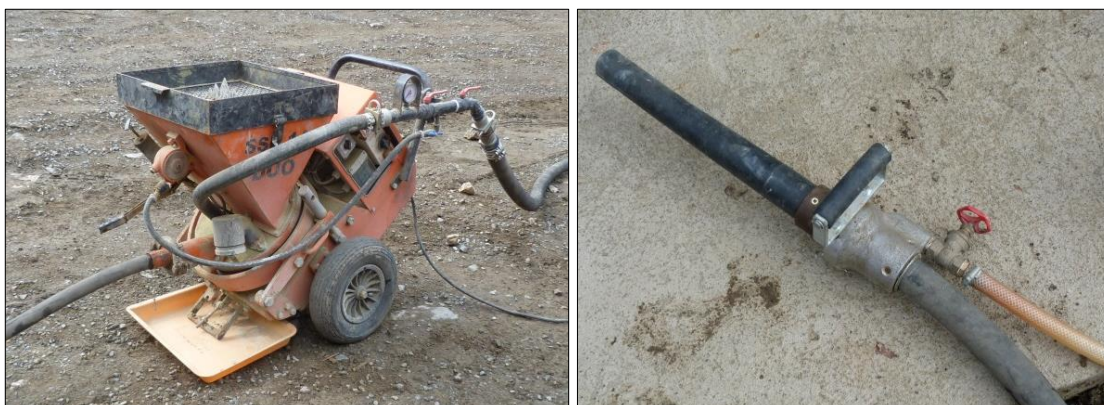
Obr. 12 – vlevo – stroj SSB 14 DUO, vpravo – tryska stroje
