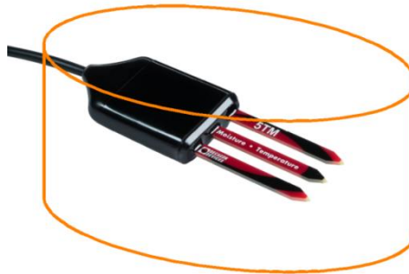
Obr. 44 – ilustrace instalovaného senzoru v prohlubni po odebraném vzorku, senzor – ilustrační foto (Decagon Devices)
