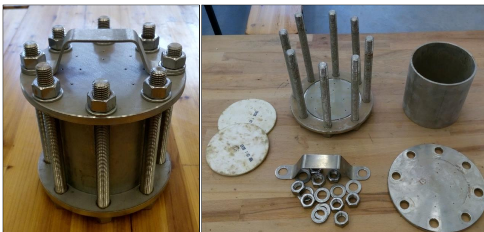
Obr. 35 – vlevo - tlaková nádoba, vpravo – komponenty tlakové nádoby
