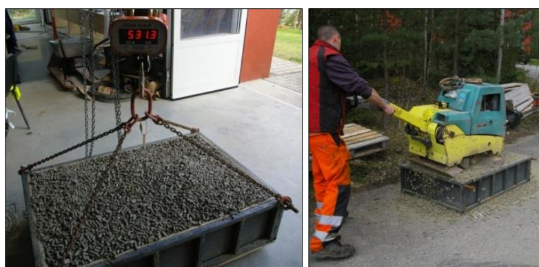
Obr. 7 – vlevo - vážení testovací bedny, vpravo – průběh hutnění (vibrační deska AMMANN)
