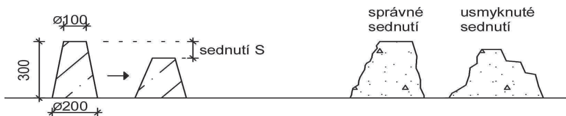
Obrázek 6: Sednutí kužele (Abrams)
