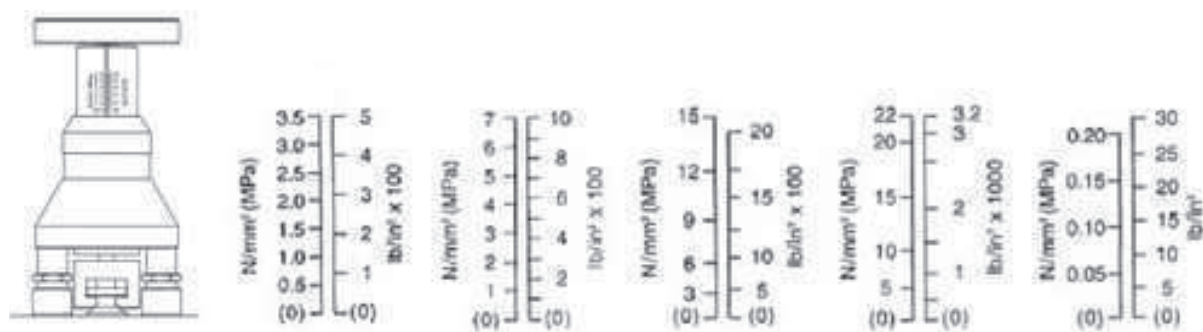
Obrázek 11: Nedestruktivní zkouška - Schmidtovo kladívko
