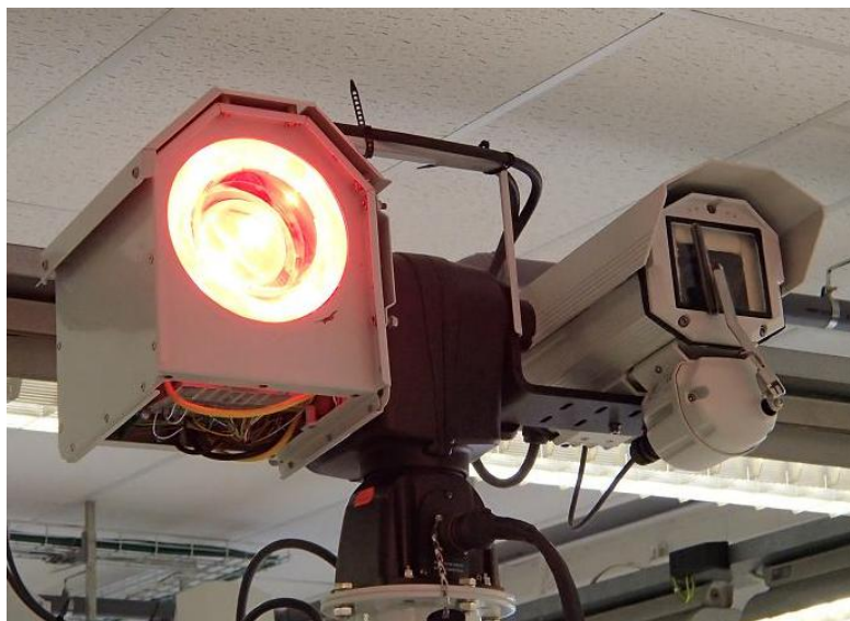
Obrázok 2 Svetelné delo napojené na PTZ kameru. Zdroj: [8]
