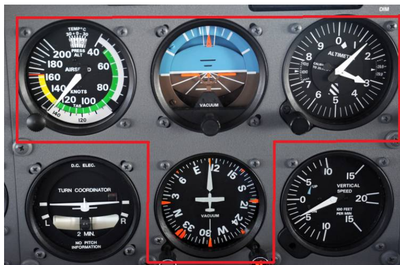
obr. 4.3 IMC - Schéma primárních letových přístrojů pro stabilizaci letounu v IMC
