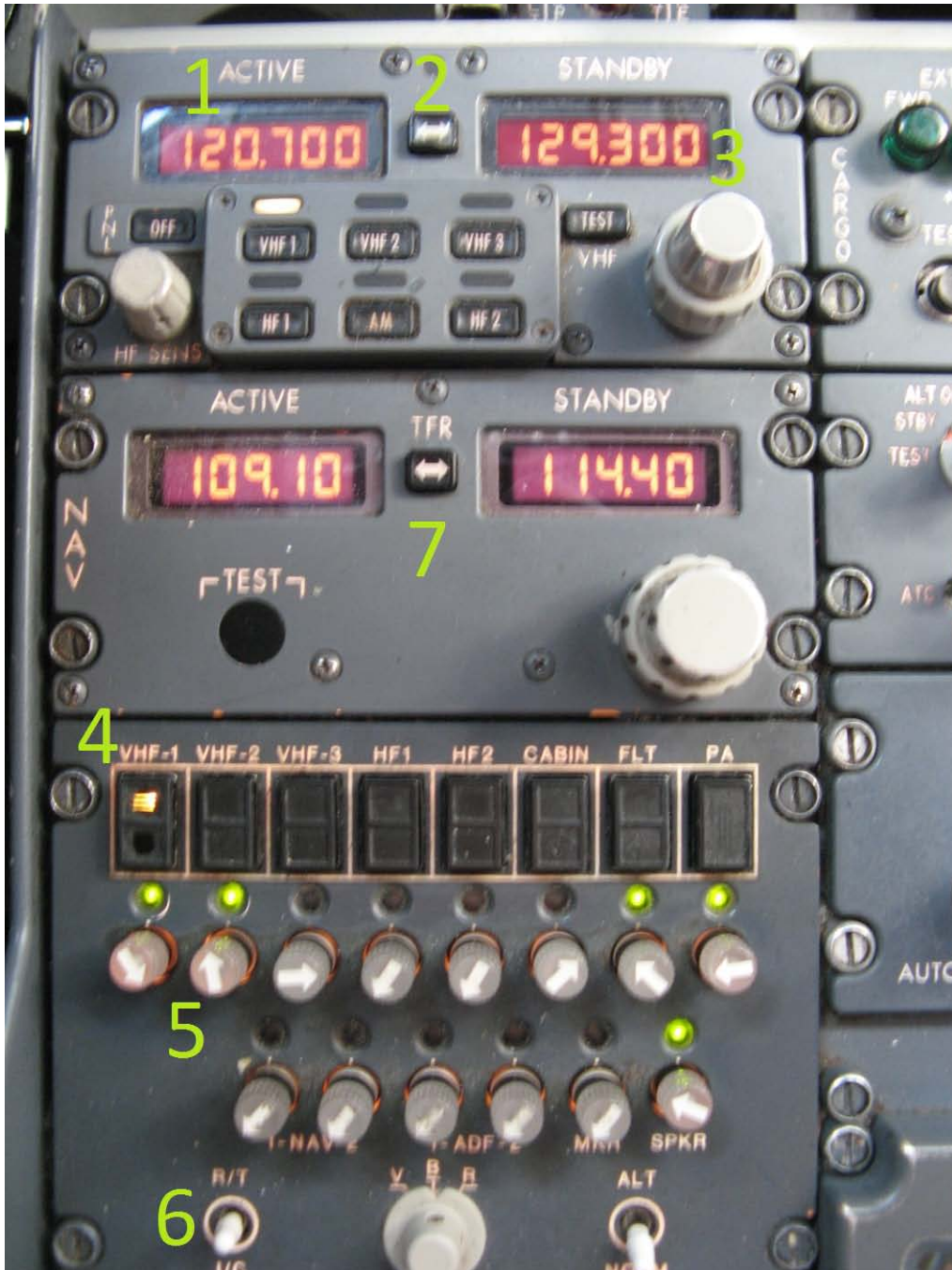
Obrázek 11 - Panel pro ovládání radiokomunikace
