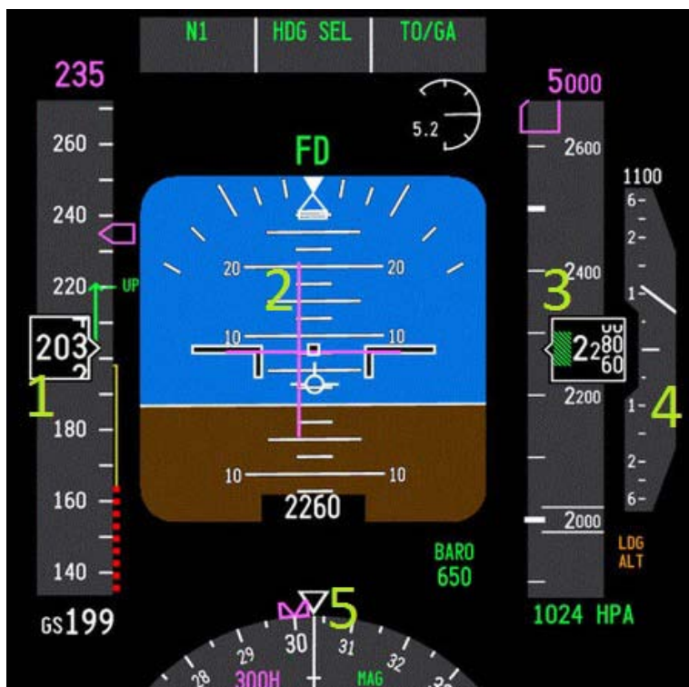
Obrázek 8 - Primární letový displej - Zdroj: www.flaps2approach.com
