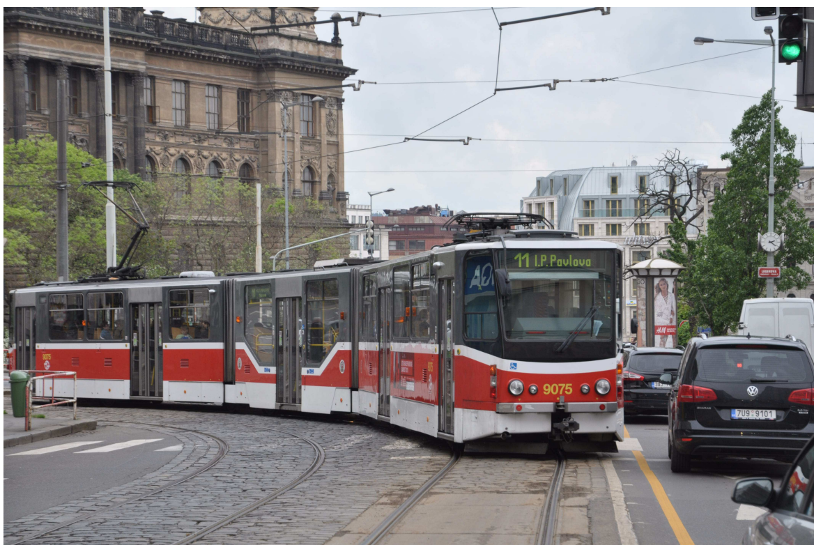
Obrázek 17 Při odbočování zasahují tramvaje do řadícího pruhu pro automobily (po dobu provozu vozů KT8 jsou zúženy řadící pruhy dočasným vodorovným dopravním značením)
