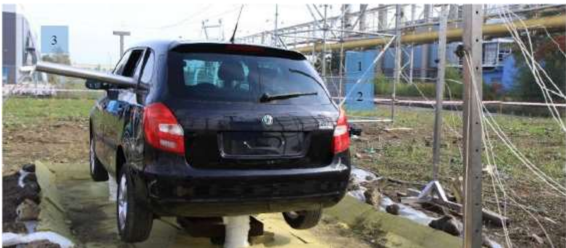
Obrázek č. 21 - Pozice vzorkovacích sond TÚPO (1 a 2) a FD (3), 1 - vzorkovací kovová sonda pro analyzátor plynů TESTO 350 L, 2 - vzorkovací kovová sonda pro ORBO, 3 – ochranná trubice pro termočláanky a kompenzační vedení detektoru CO [1]
