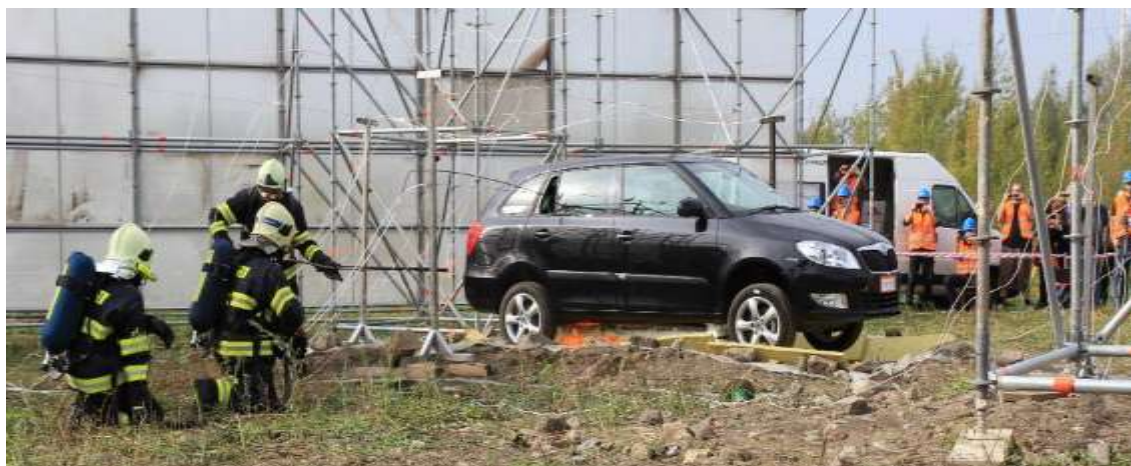
Obrázek č. 20 - Pohled na zkušební automobil v záchytné jímce těsně po zapálení [1]
