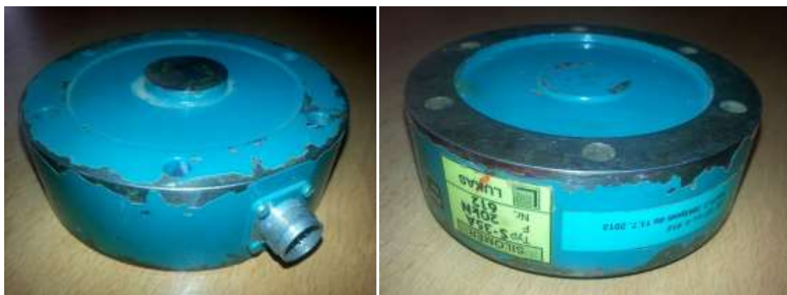
Obrázek č. 18 – siloměr o průměru 150mm a výšce 35mm [1]
