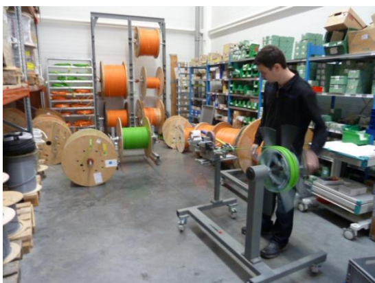
Obrázek 27: Příprava a motání kabelu
