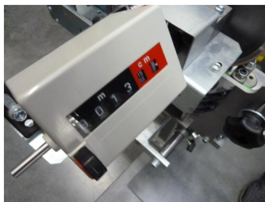
Obrázek 26: Měření délky kabelu
