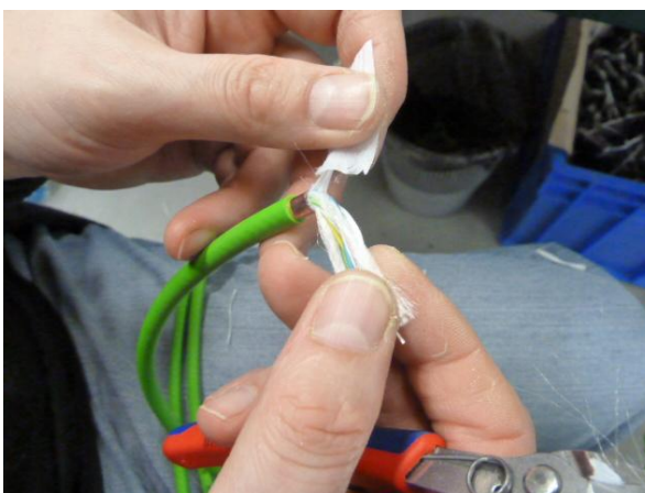
Obrázek 31: Čištění datového kabelu a očištěný kabel Zdroj: Autorka
