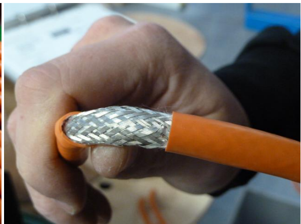
Obrázek 30: Označení kabelů kvůli jejich záměně a chybné odpláštění Zdroj: Autorka
