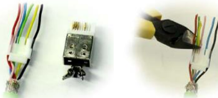
Obrázek 11: Navlečení vodičů do vnitřní části konektoru a jejich následné zastřížení Zdroj: http://www.yamaichi.de
