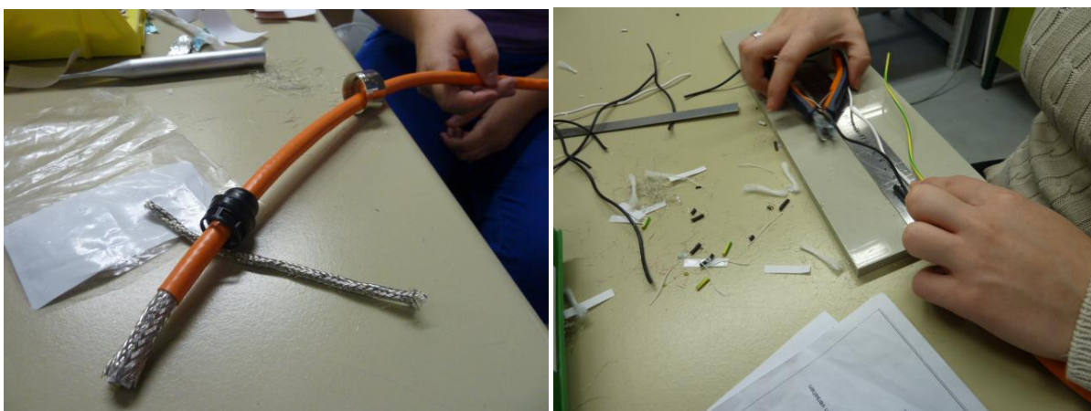
Obrázek 33: Navlékání součástek na stranu A , zastřížení strany B Zdroj: Autorka
