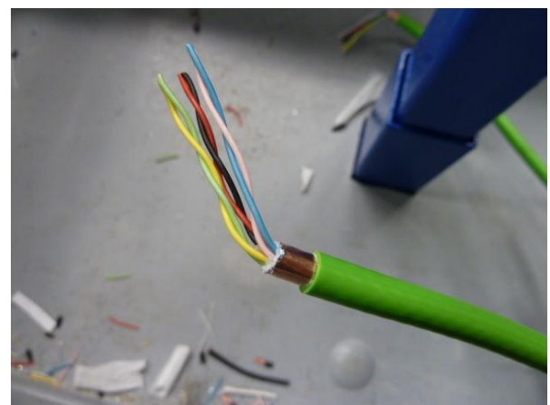
Obrázek 31: Čištění datového kabelu a očištěný kabel Zdroj: Autorka
