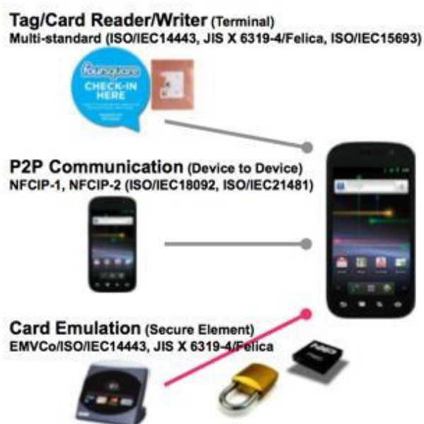
Obrázek č. 17: Přenosové režimy mobilních telefonů technologií NFC, Zdroj: ( www.nfc-formu.com )
