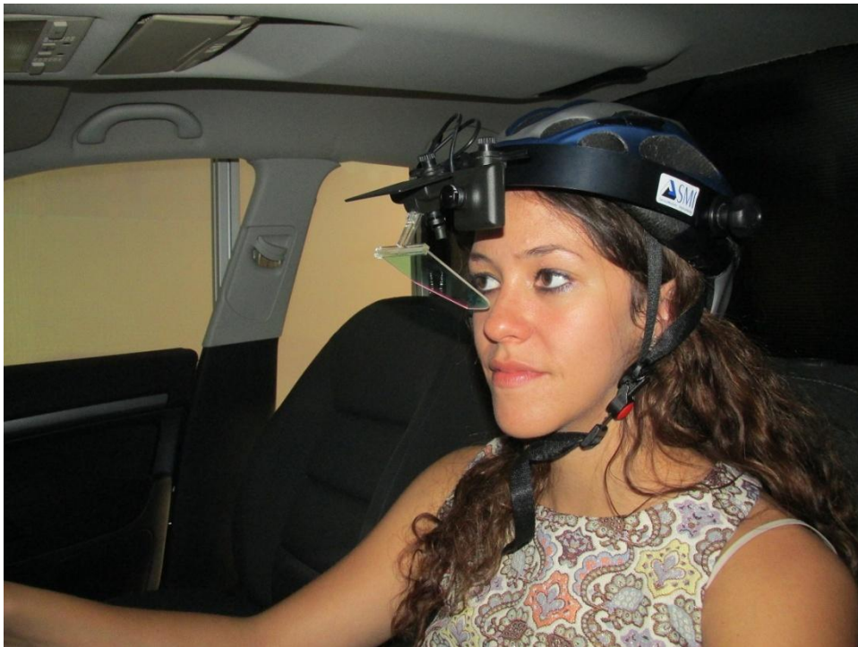
Obrázek 22 Testovaná řidička při kalibraci eye trackingu
