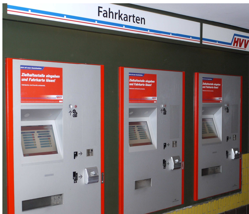
Obrázek I: Víceúčelové automaty na jízdenky ve stanicích hamburského metra a jednotné symboly systému HVV Zdroj: hvv.de
