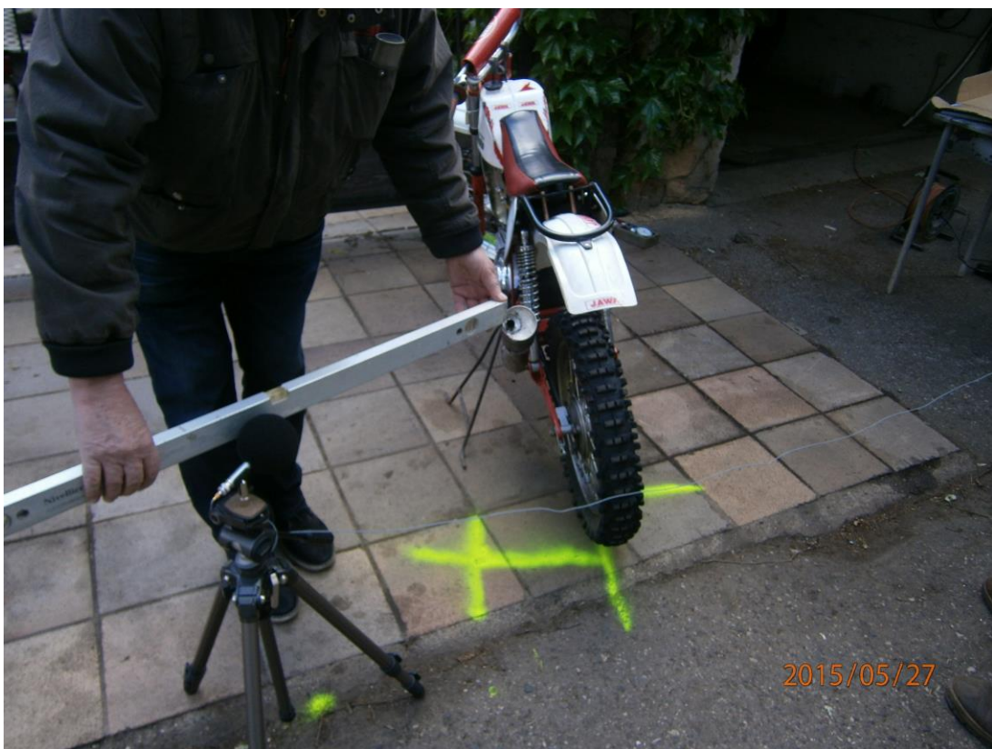
Obrázek 4 Hrdlo výfuku muselo být se stejnou úrovní s hlukoměrem (Kubka Pavel)
