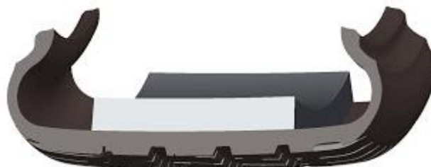
Obrázek 27: Řez pneumatikou s izolační vrstvou [7]
