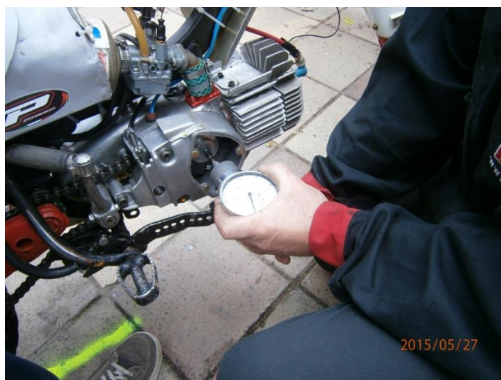
Obrázek 38: Použití hlukoměru při měření (Kubka Pavel)
