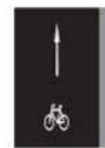
Obrázek 1: Vodorovné dopravní značení vyhrazeného pruhu pro cyklisty V14
