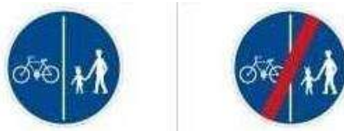
Obrázek 12: Svislé dopravní značení stezky pro chodce a cyklisty s odděleným provozem C10a, C10b
