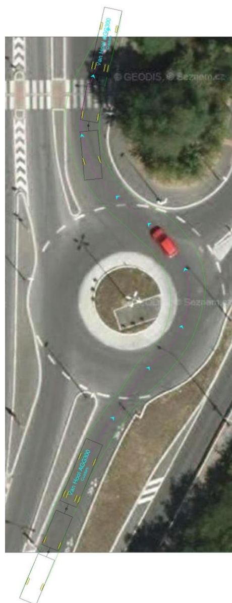
Obrázek 16. Simulace průjezdu dvoukloubového autobusu okružní křižovatkou u zastávky Roztocká. Zdroj mapového podkladu: [3]
