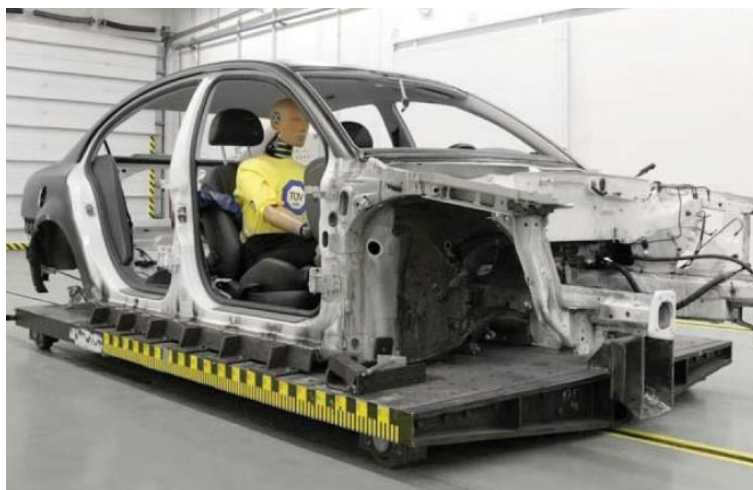
Obr. 20 – Urychlovací vozík se skeletem vozidla. (13)
