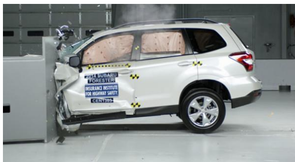
Obr. 15 – Čelní nárazová zkouška s offsetem 40 %. (10)
