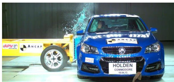
Obr. 17 – Boční nárazová zkouška mobilní bariérou. (11)
