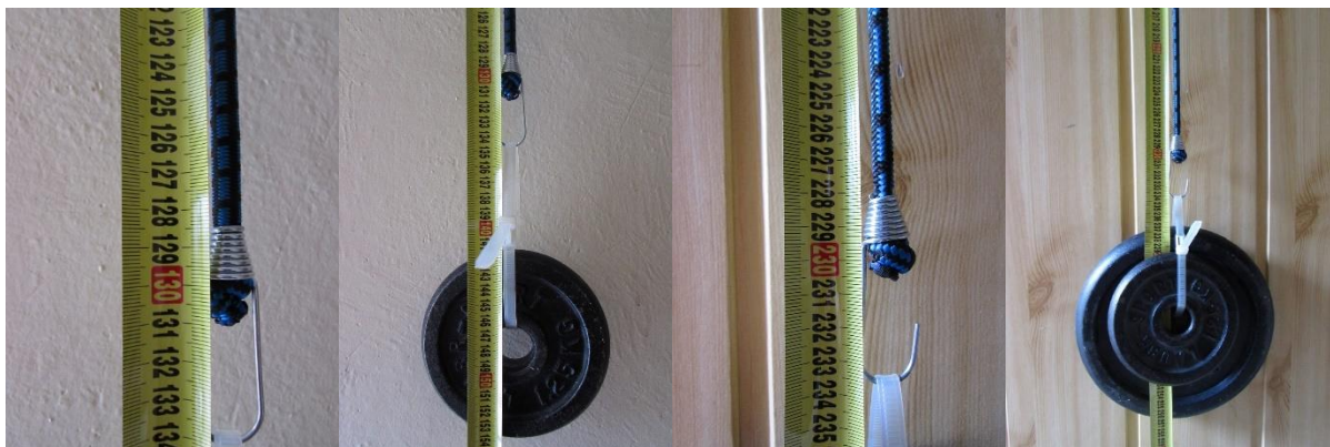
Obr. 31 – Měření tuhostí pryžových lan.
