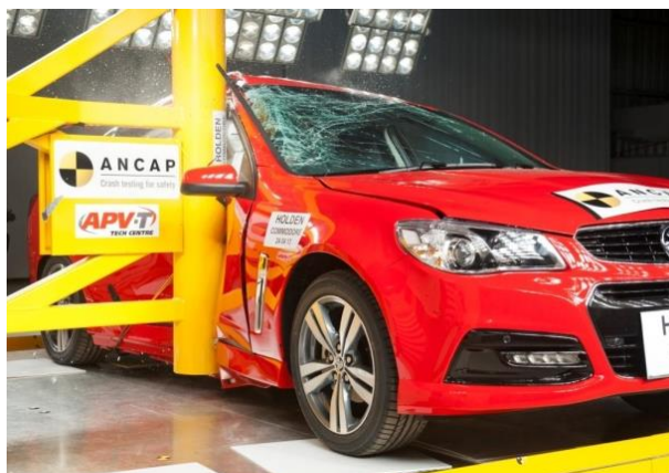
Obr. 19 – Boční nárazová zkouška do sloupu. (11)
