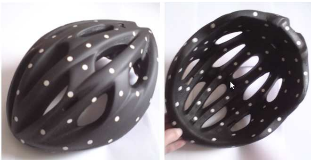
Obrázek 7.4: Přelakovaná a pozičními terčičky polepená přilba
