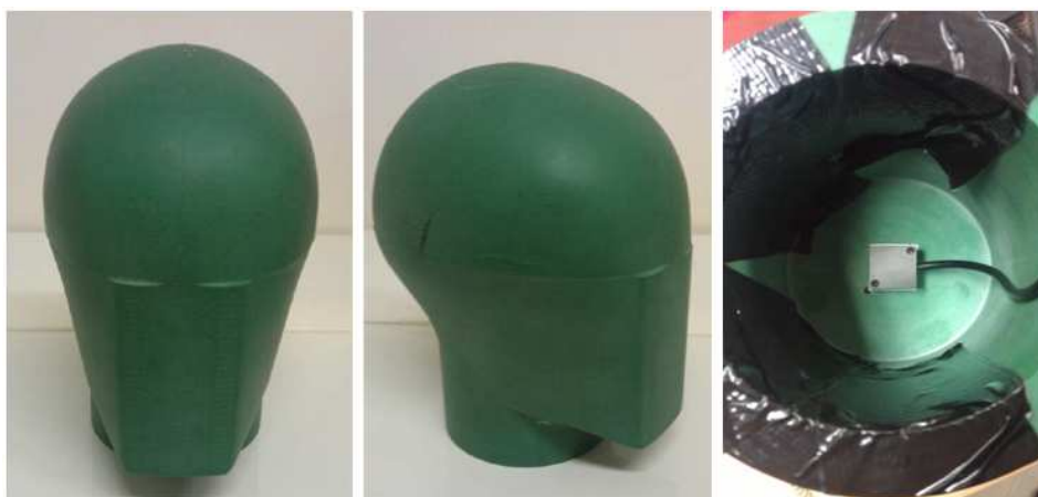
Obrázek 9.2: Maketa hlavy a její osazení 3-osým akcelerometrem
