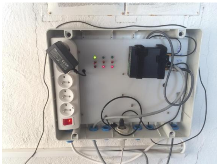
Obrázek 16: Zapouzdření přijímače na střeše strahovských kolejí [zdroj Ing. Martin Zach]
