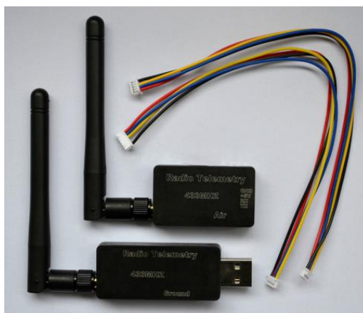
Obrázek 11: Pozemní a palubní část telemetrického přenosu [41]
