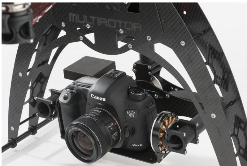
Obrázek 5: Dvouosá stabilizace kamery [30]
