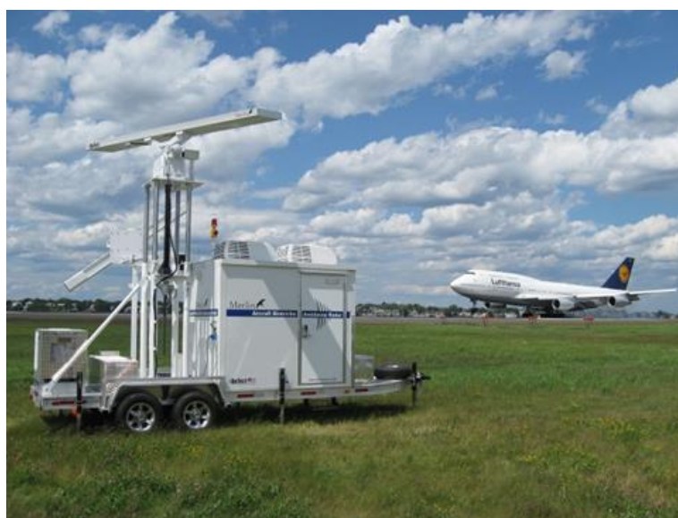
Obrázek 20. Ptačí radar instalovaný na letišti King Abdullah Bin Abdulaziz v Saudské Arábii [16]
