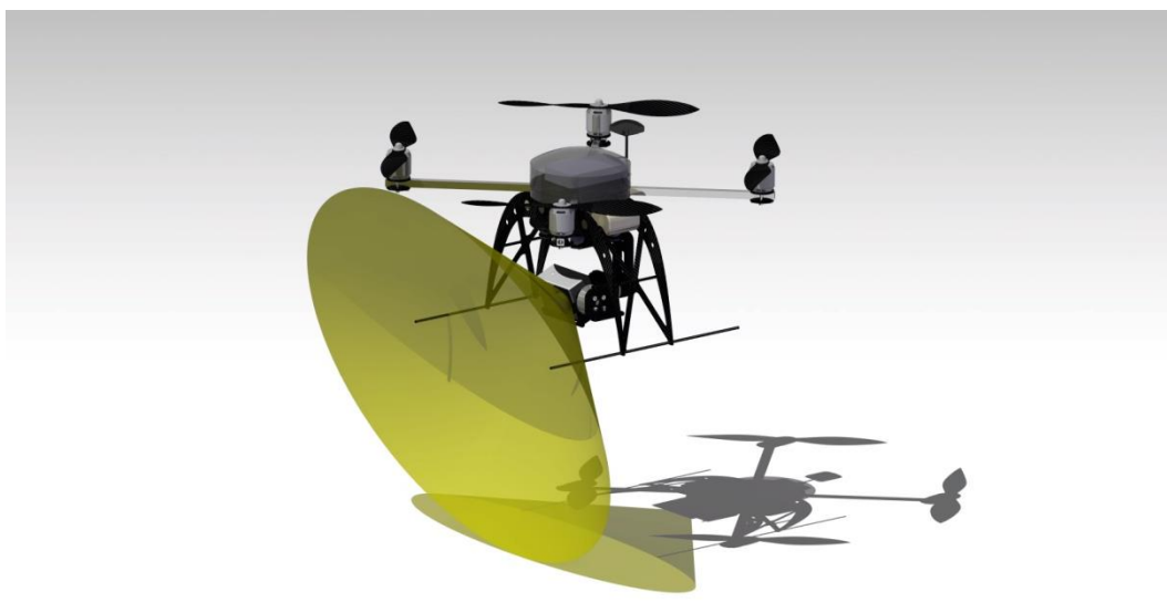
Obrázek 18: Kvadrokoptéra s naznačenou oblastí záběru kamery
