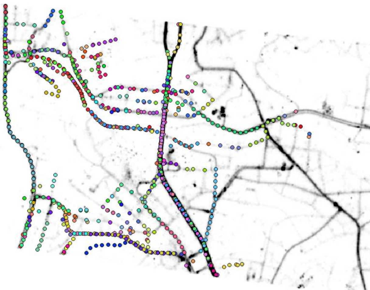
Obr. 23: Model silniční sítě vytvořený hledáním křížení
