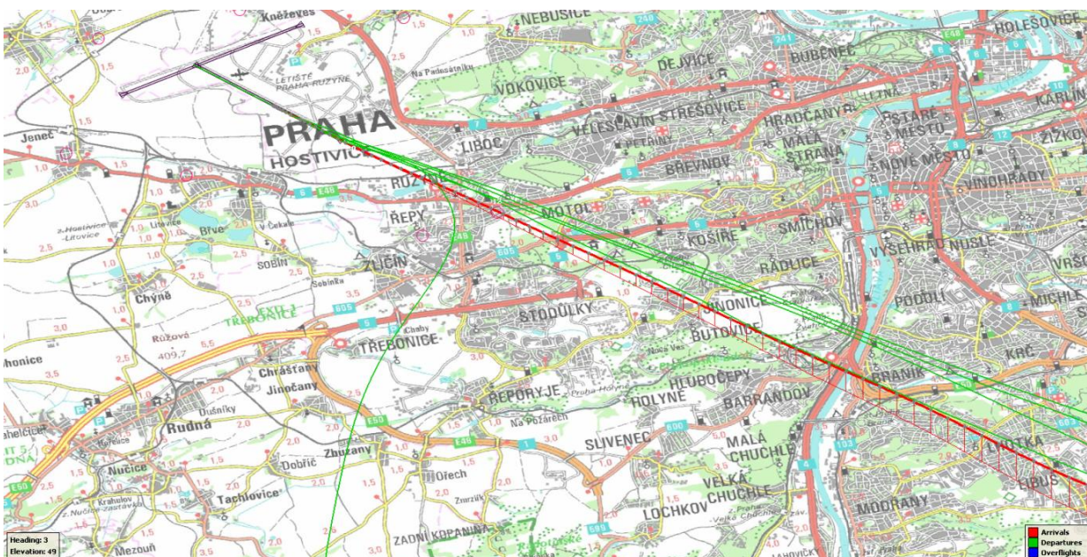
Obrázek 12 : Záznam trajektorie přiletu a odletů v oblasti přiblížení na RWY 30 zobrazeném v prostředí systému ANOMS 9. [30]
