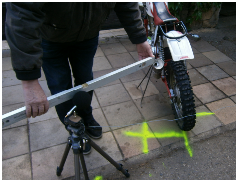
Obrázek 45: Kontrola rovnoběžnosti osy mikrofonu
