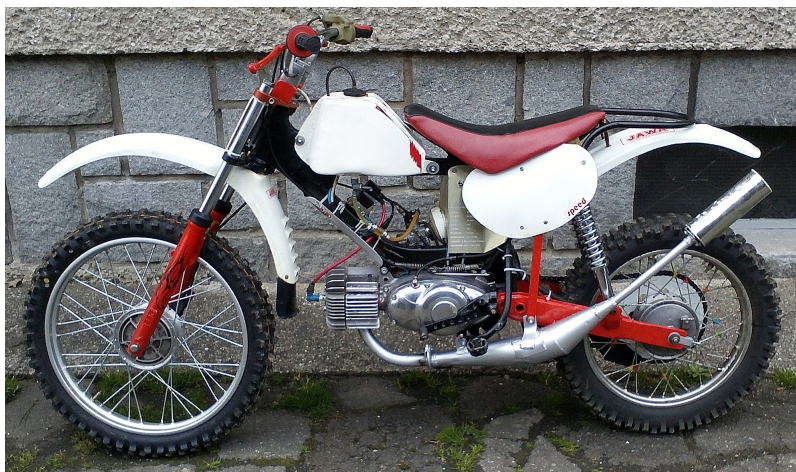
Obrázek 22: Uchycení výfuku na motocyklu
