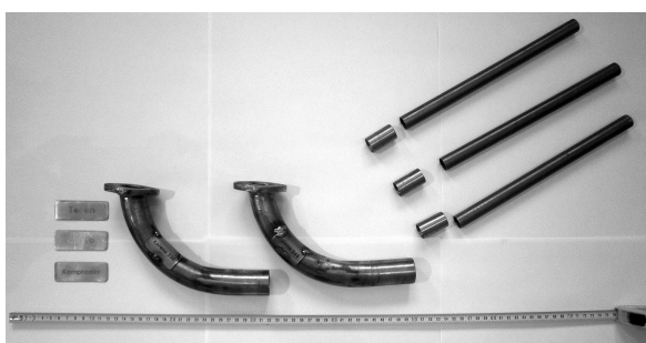
Obrázek 23: Výfuková kolena, výletové trubičky a mezikusy k jejich upevnění
