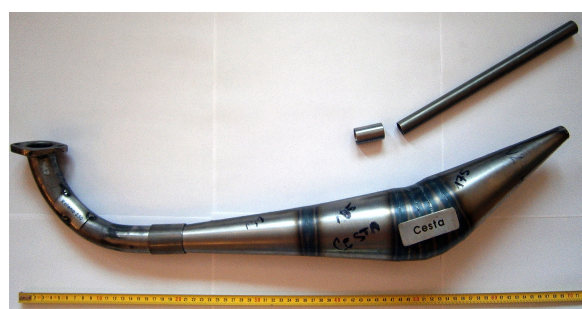
Obrázek 24: Ukázka provizorně poskládaného výfuku, varianta Cesta
