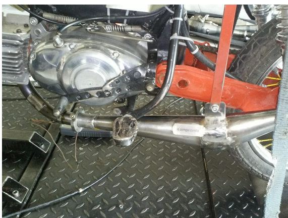
Obrázek 38: Uchycení kolene výfuku s možností zkrácení o 10 mm
