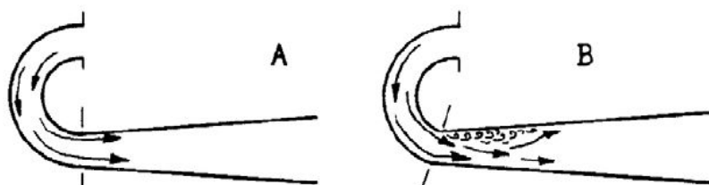
Obrázek 9: Správná konstrukce (A) vs. špatné napojení výfukového kolene na difusor (B) [2]
