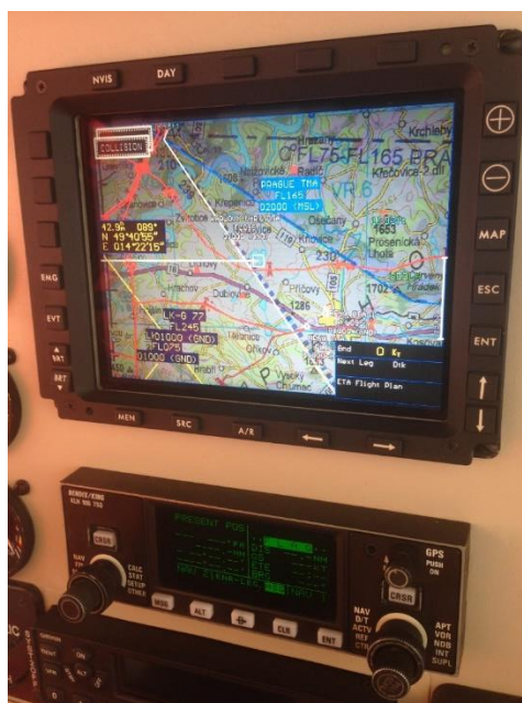
Obrázek 7: Navigační GPS systém v W3-A Sokol (Zdroj:vlastní)
