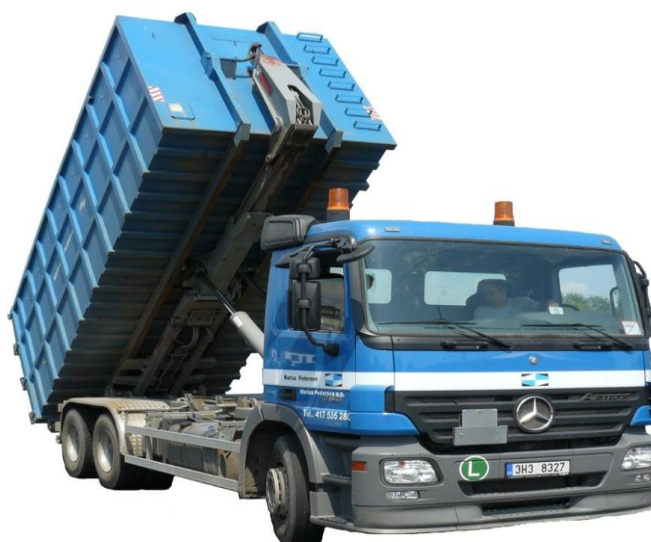
Obrázek 9: Vozidlo - nosič kontejnerů ABROL [26]
