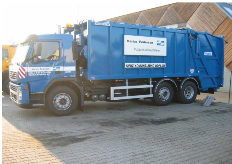
Obrázek 6: Vozidlo PRESS třínápravové s lineárním lisováním [26]
