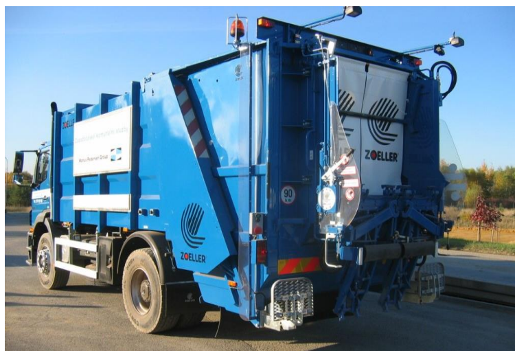
Obrázek 4: Vozidlo PRESS dvounápravové s lineárním lisováním [26]
