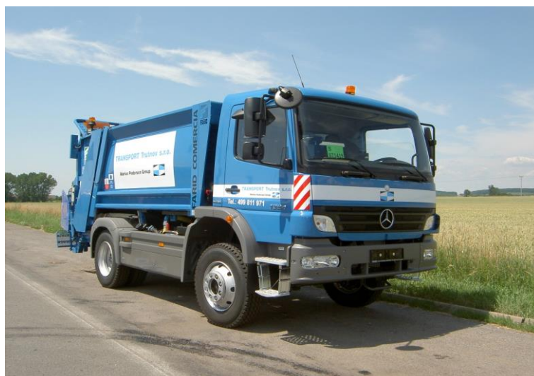
Obrázek 5: Vozidlo PRESS dvounápravové s lineárním lisováním [26]
