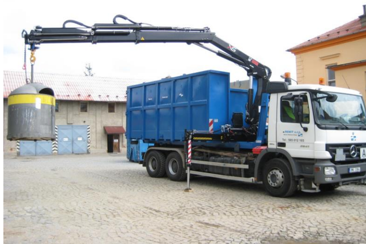
Obrázek 8: Vozidlo třínápravové s velkoobjemovým kontejnerem a hydraulickou rukou [26]
