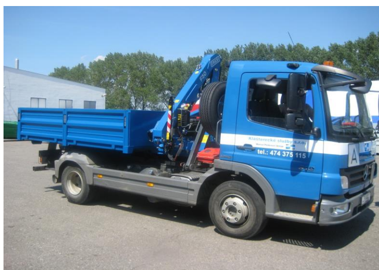
Obrázek 7: Vozidlo dvounápravové s hydraulickou rukou [26]
