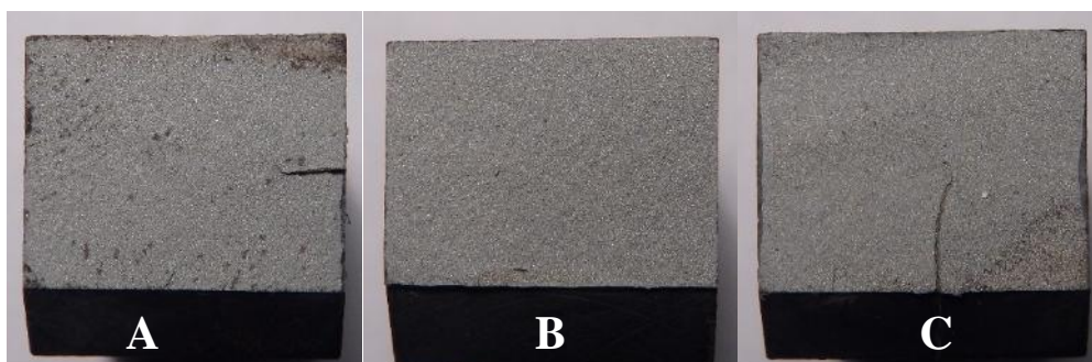
Obr. 36: Lomové plochy vzorků a) T = 90\text{ }^{\circ}\text{C} , b) T = 100\text{ }^{\circ}\text{C} , c) T = 135\text{ }^{\circ}\text{C} .
