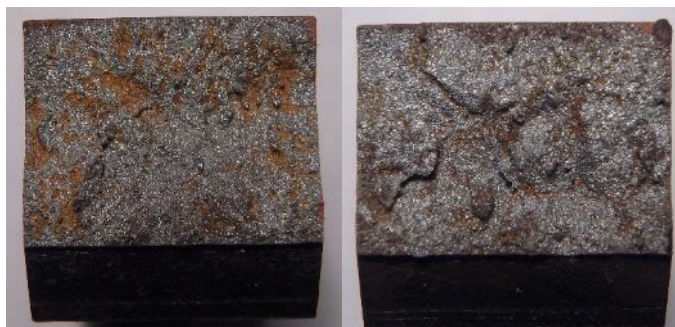
Obr. 38: Lomové plochy vzorků přeražených při teplotě -190\text{ }^{\circ}\text{C}
