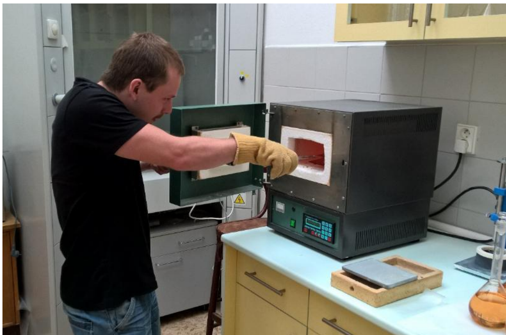
Obr. 15: Tepelná úprava vzorků v laboratorní peci
