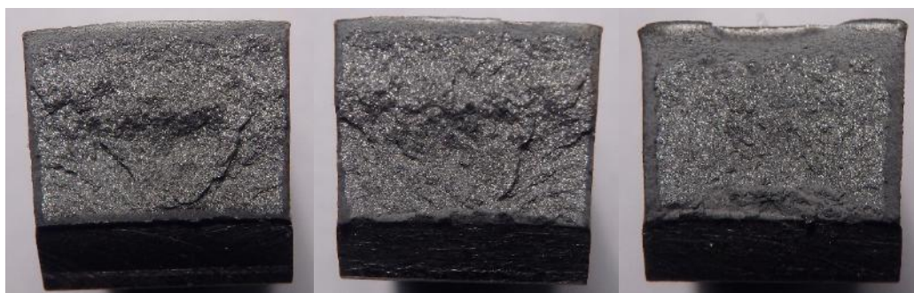
Obr. 35: Lomové plochy vzorků při teplotě 30\text{ }^{\circ}\text{C}
