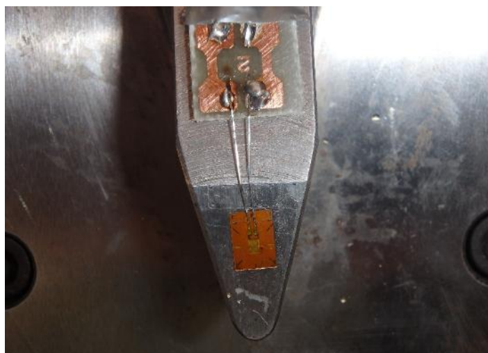
Obr. 24: Umístění tenzometru na spodní straně břitu
