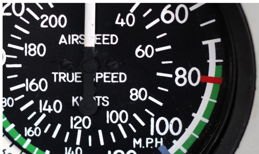
Obrázek 26: Počátek bílého a zeleného oblouku na rychloměru (pořízeno autorem)
