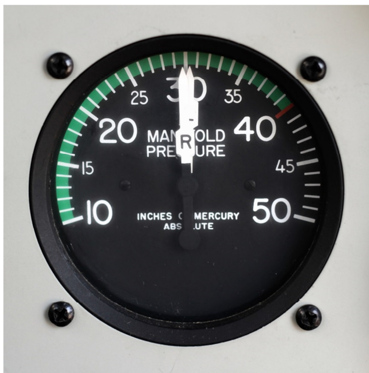
Obrázek 3: Ukazatel plnicího tlaku (pořízeno autorem)
