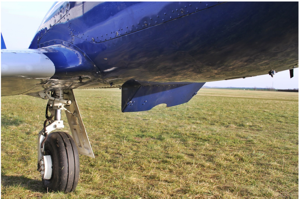
Obrázek 4: Otevřená klapka chlazení (pořízeno autorem)
