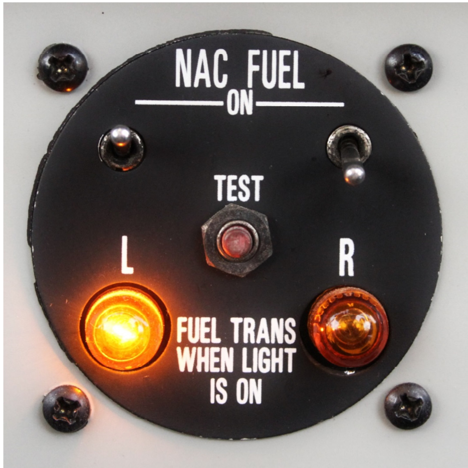
Obrázek 10: Ovladač přídatných nádrží (pořízeno autorem)
