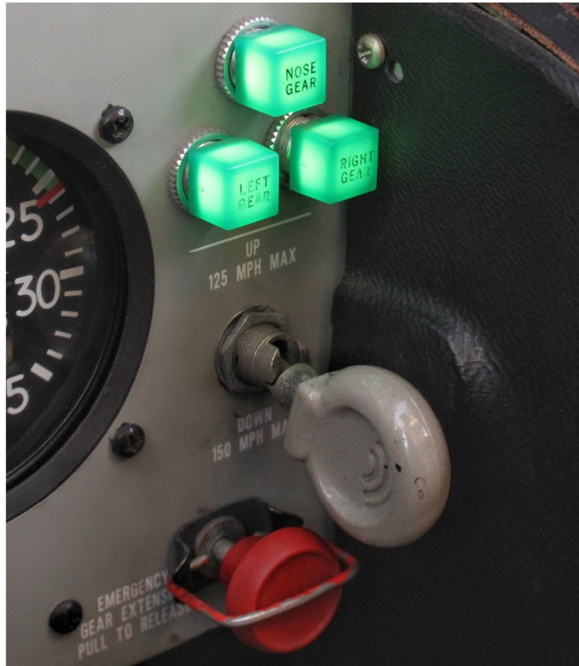
Obrázek 27: Ovládání a indikace podvozku (pořízeno autorem)
