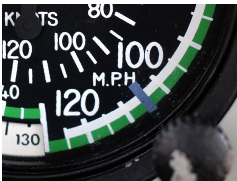
Obrázek 24: Modrá radiální čára na rychloměru (pořízeno autorem)
