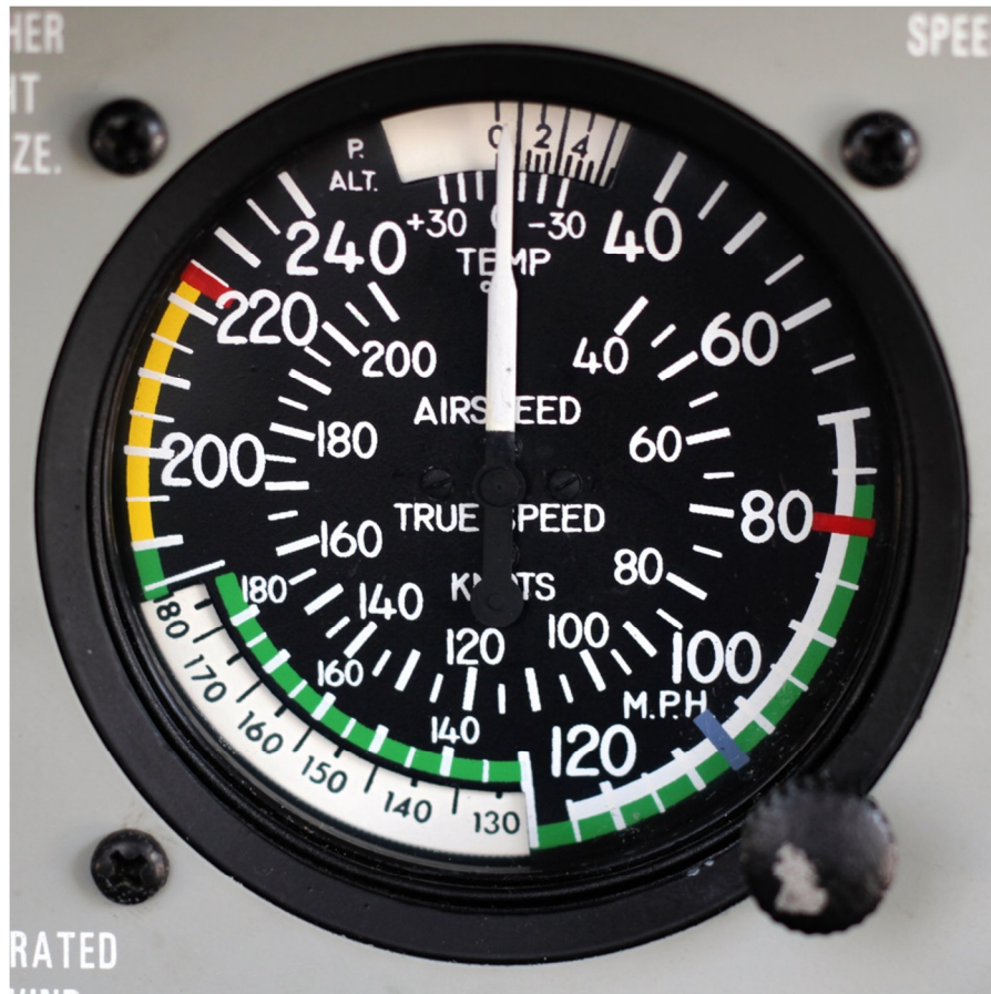
Obrázek 1: Rychloměr (pořízeno autorem)
