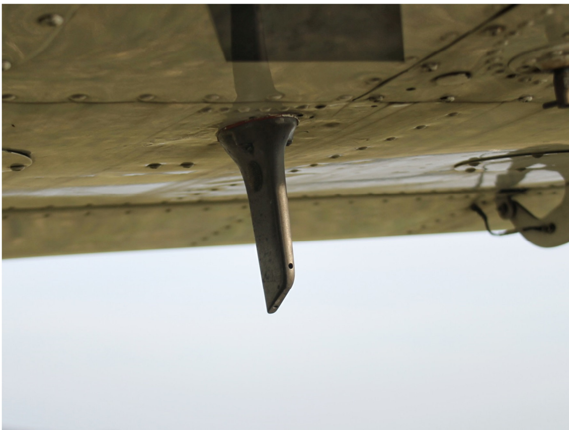
Obrázek 11: Pitotova trubice (pořízeno autorem)
