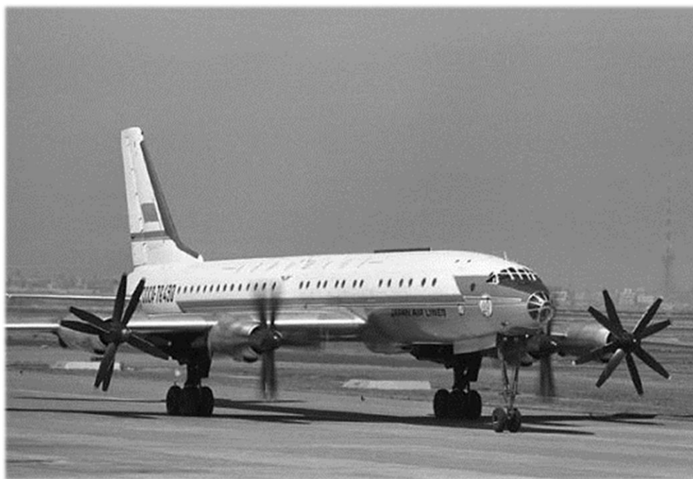
Obr. 7 Tupolev Tu-114 běžně používal při pojíždění pouze vnitřní motory
