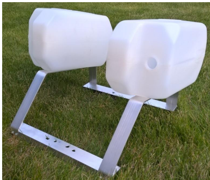
Obrázek 17 Držák s instalovanými palivovými nádržemi
