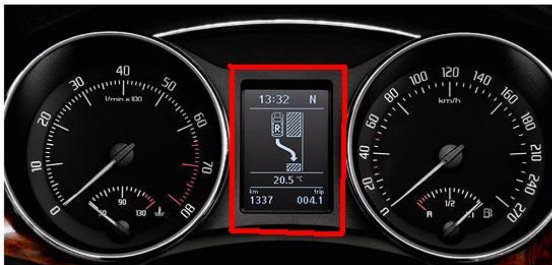
Obr.č.21: Multifunkční ukazatel provozních údajů (MFA)
