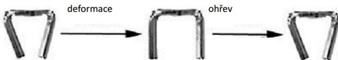
Obr. 14: Princip osteosyntetické svorky NiTi [21]
