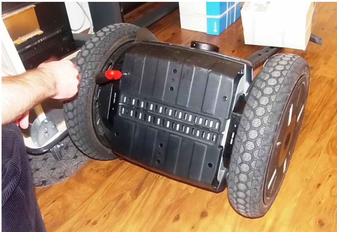
Obrázek 5 - fotografie spodní části Segwaye s bateriemi
