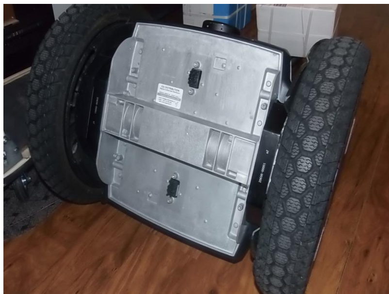
Obrázek 6 - fotografie spodní části Segwaye bez baterií
