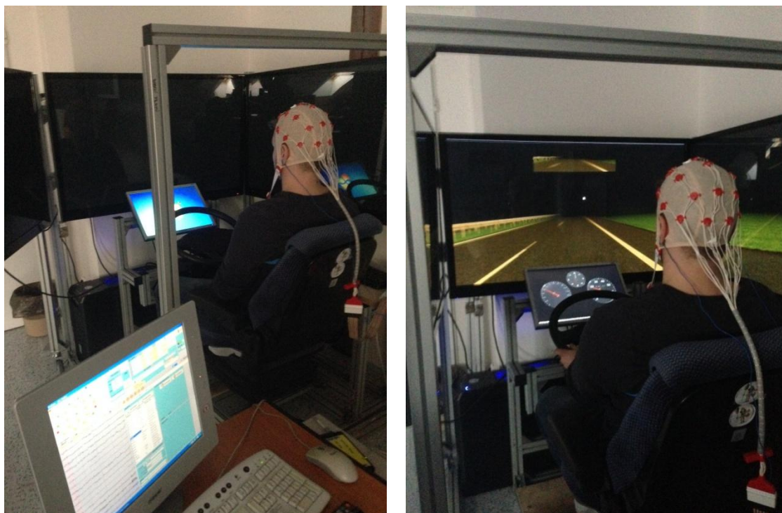
Obr.6 – Vlevo otevřený simulátor s testujícím řidičem a PC snímající EEG, vpravo simulátor v provozu
