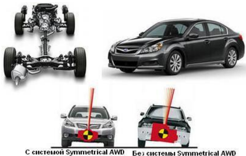
Obr. 52 Velikost klopivého momentu v závislosti na výšce těžiště vozidla - vlevo dole podélně uložený motor typu boxer, vpravo dole příčně uložený řadový motor
