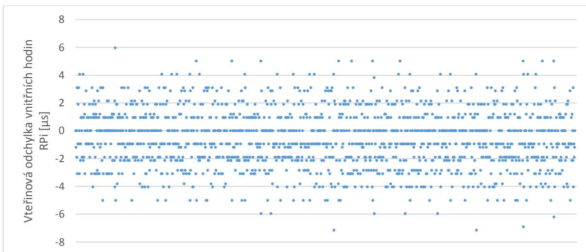
Obrázek 3 – Měření vteřinové odchylky vnitřních hodin RPi. Zobrazeno je 1543 hodnot, měření probíhalo přibližně 26 minut.
