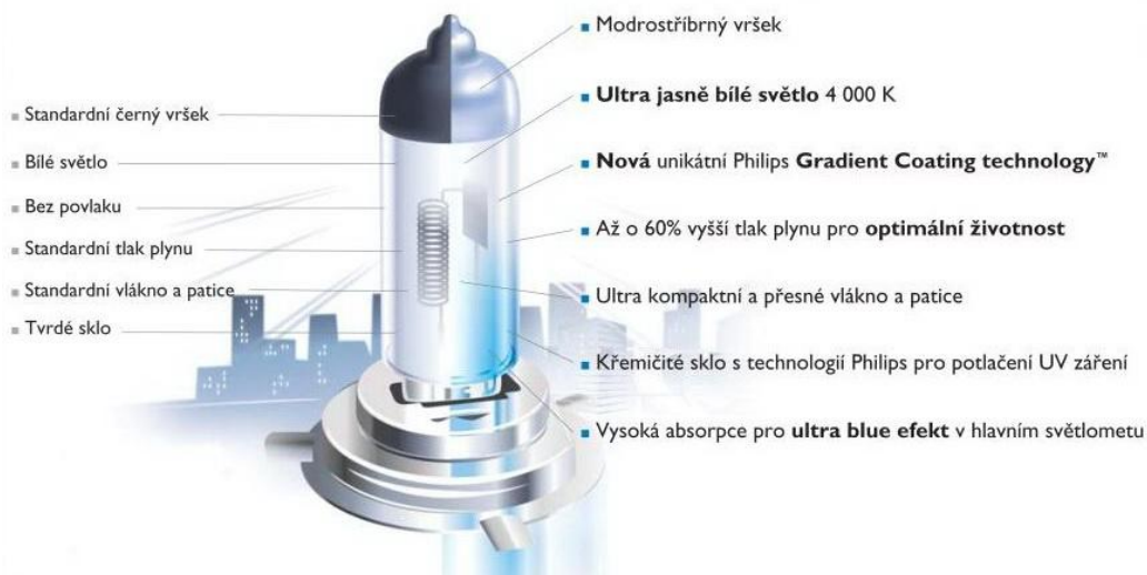
Obr. 24 Srovnání BlueVision s běžnou halogenovou žárovkou [16]
