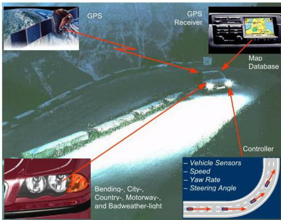
Obr. 58 Součásti systému adaptivních světlometů ALC [25]
