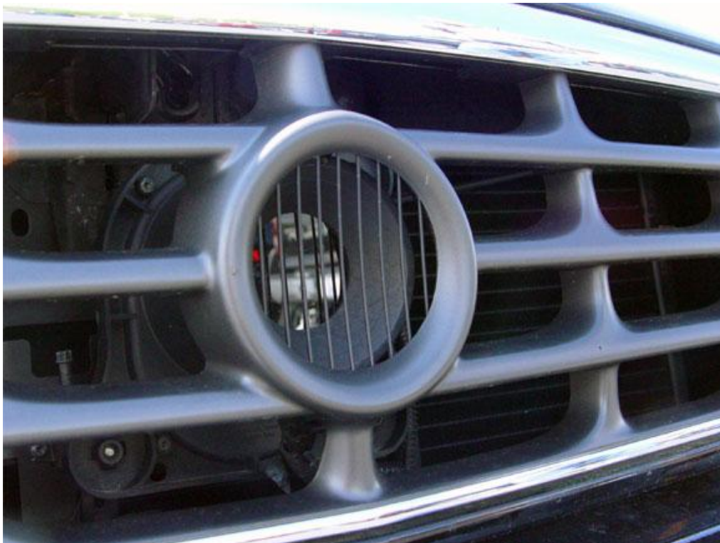
Obr. 61 Infračervená kamera v masce chladiče [20]
