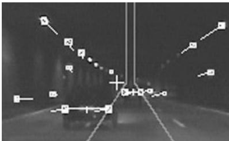
Obr. 70 Výsledný obrazový výstup detekce vozidel [33]
