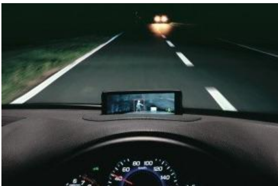
Obr. 76 Umístění displeje nočního vidění u vozu Honda [34]
