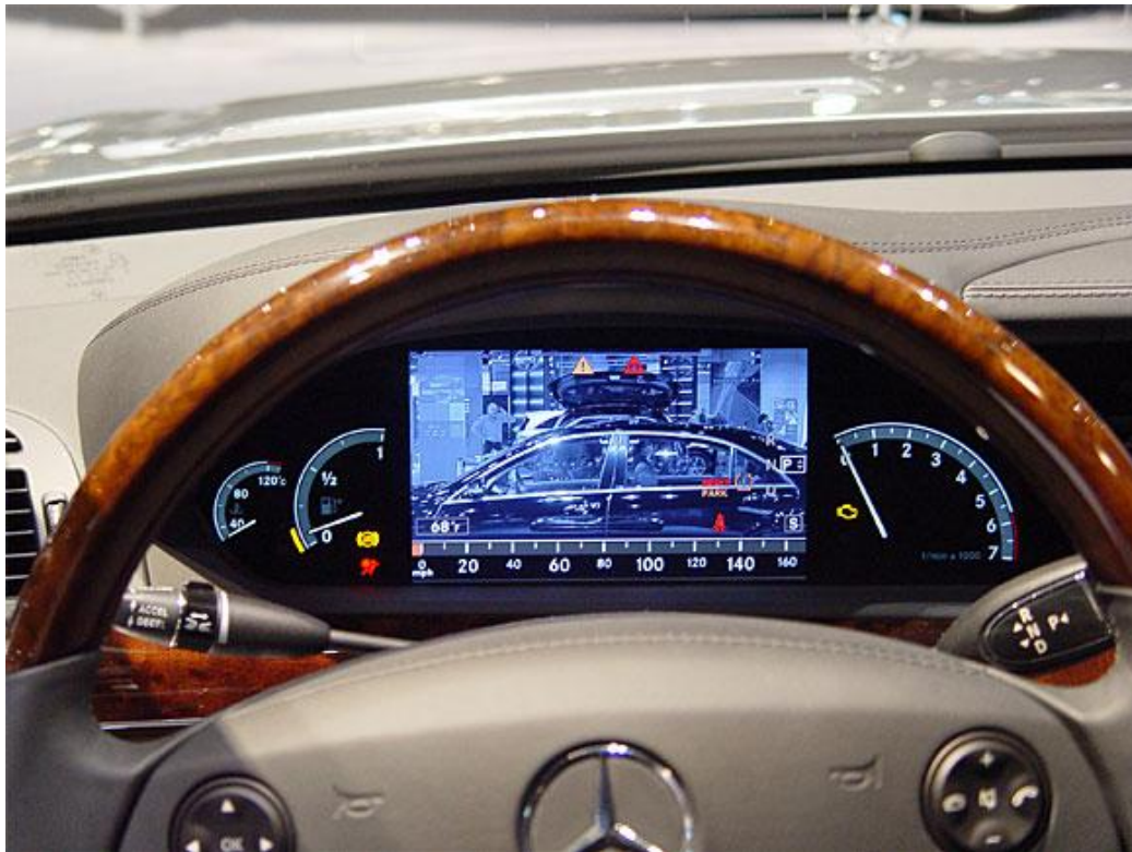
Obr. 62 Ukázka nightvision zobrazení u vozů Mercedes-Benz [20]
