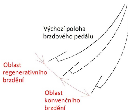
Obrázek 4—2: Manuální ovládání aktivace ukládání energie
