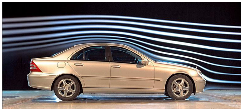
Obrázek 1—10: Obtékání vozidla v aerodynamickém tunelu [74]
