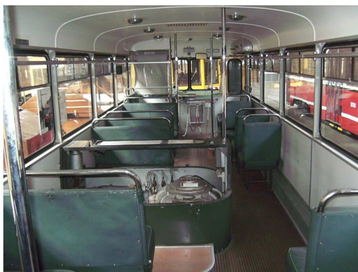
Obrázek 3—9: Setrvačnick umístěný v prostoru pro cestující [104]
