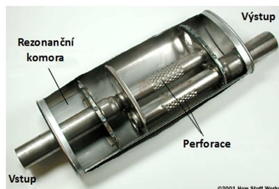
Obrázek 2—6: Vnitřní uspořádání tlumiče [88]
