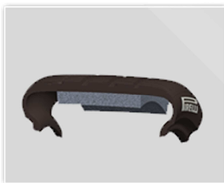
Obrázek 2—7: Pneumatika s protihlukovou úpravou [89]
