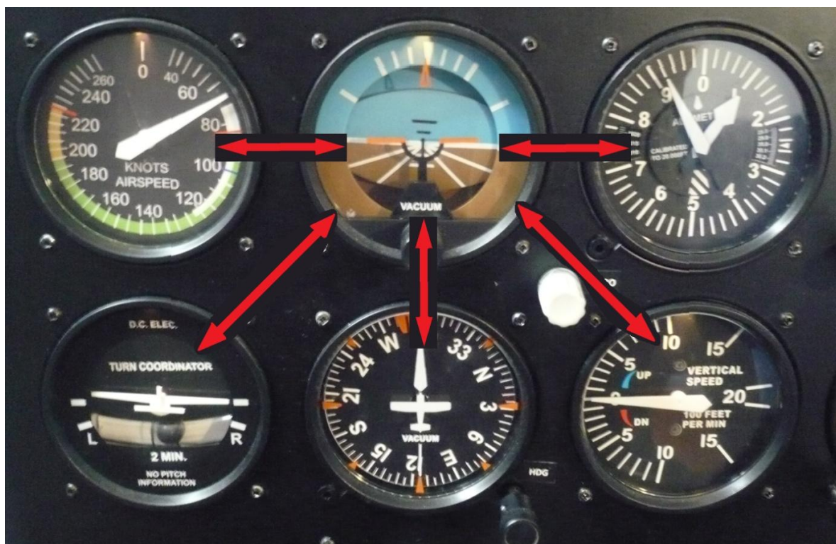
Obrázek A1: Princip radiální metody sledování přístrojů
