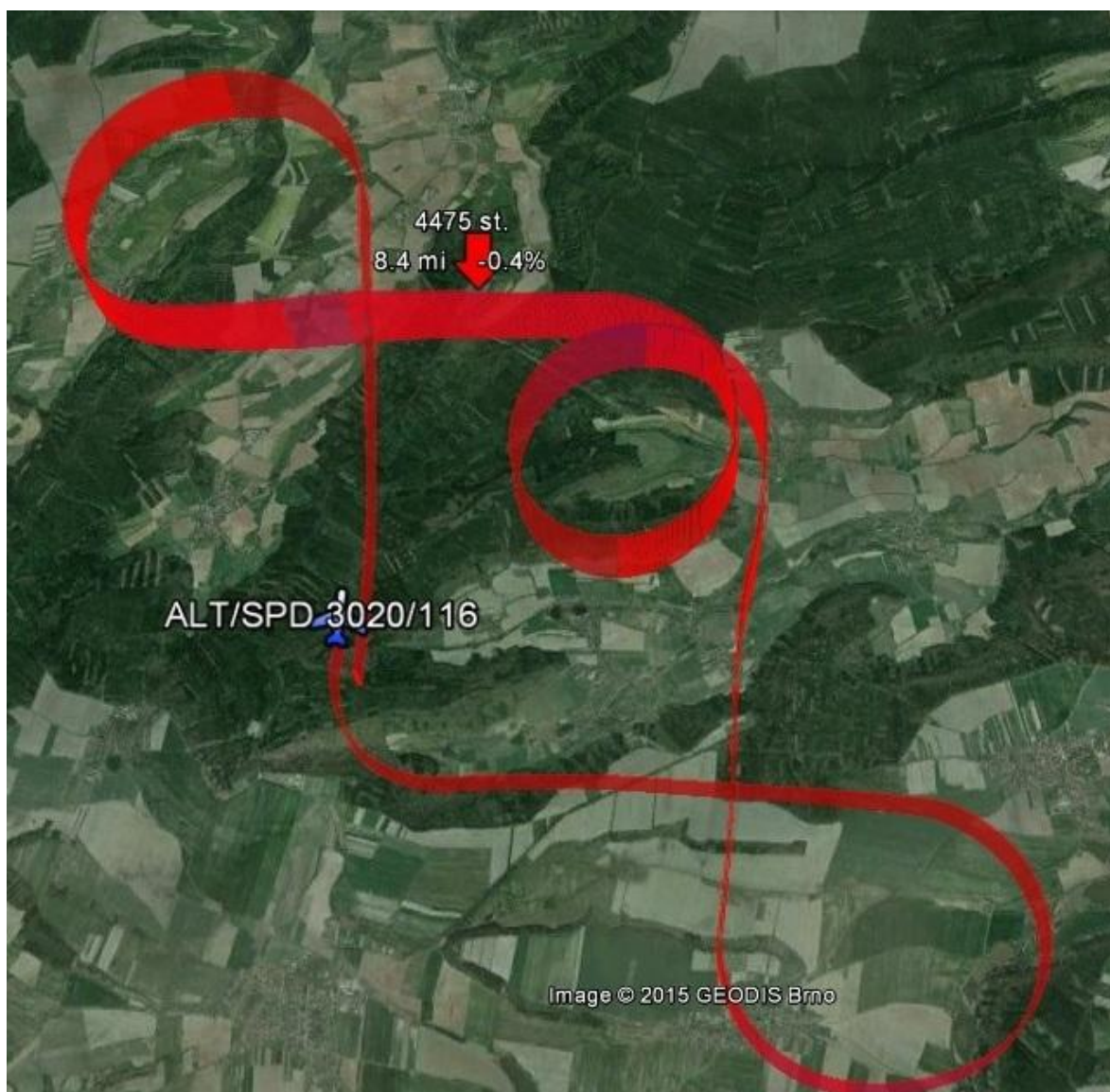
Obrázek 3. Trajektorie letu na instruktorském počítači zobrazená využitím programů Google Earth a Instructor Station [10]
