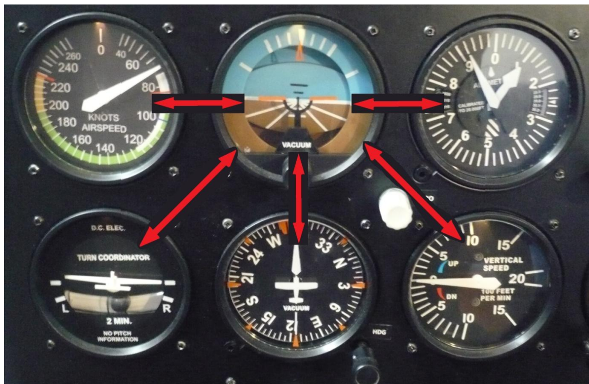
Obrázek 2. Způsob přenášení pohledu mezi přístroji využitím metody radiálního sledování
