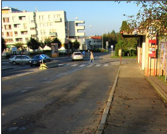
[obr.3] umístění zálivu zastávky vytvářející nadměrně široký vjezd do křižovatky ve směru na Prahu
